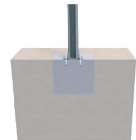
Tubería fijada sobre dado de concreto
